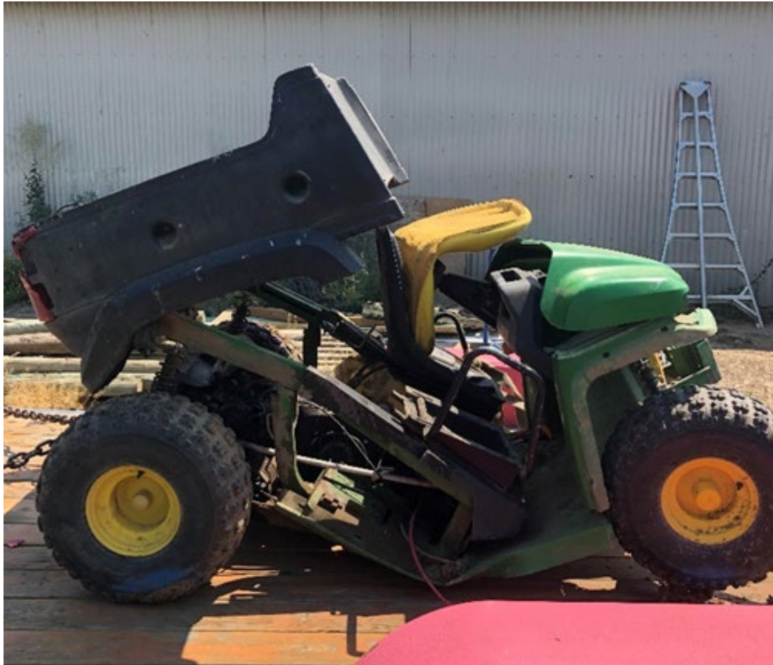
Fotografía 1. Vehículo utilitario (UTV) con daños provocados por el vehículo de pasajeros.
