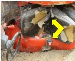
El cinturón de seguridad del operador estaba desabrochado en el tractor que se volcó.
