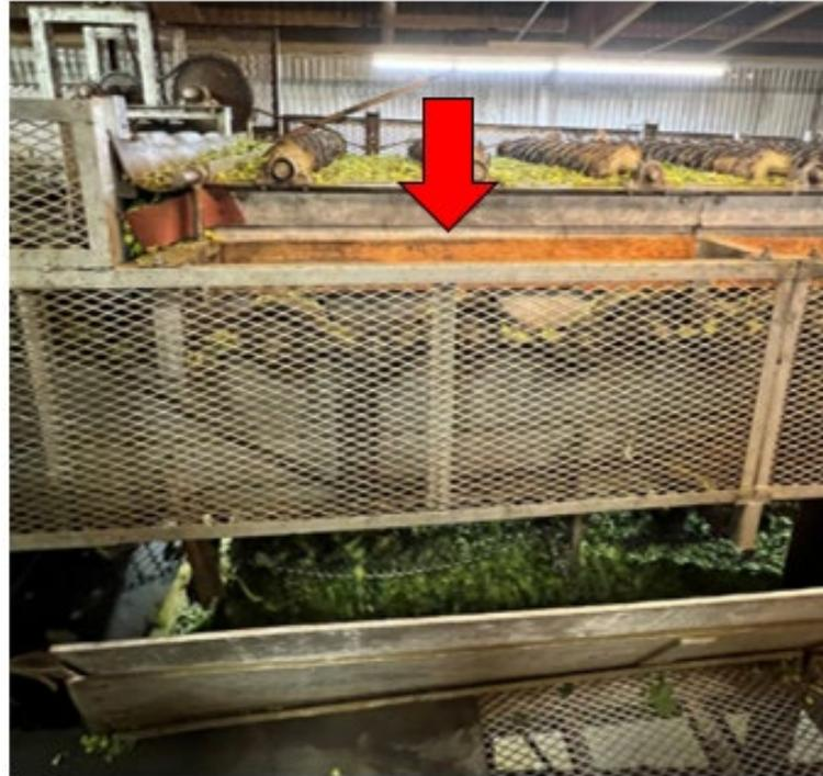
**Fotografía 1.** La máquina cosechadora de lúpulo en la que el trabajador destruyó su mano al tratar de retirar residuos. La flecha muestra la abertura sobre el protector horizontal de malla de acero y la transmisión de cadena y engranajes en donde el trabajador introdujo la mano. Debe señalarse la falta de advertencias de peligro y letreros sobre bloqueo y etiquetado en la máquina.
