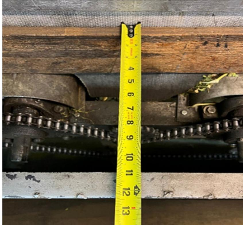
**Fotografía 2.** Acercamiento a la abertura de 11 pulgadas sin protección sobre la transmisión de cadena y engranajes en donde el trabajador introdujo la mano, que fue aplastada. Después del incidente se encontraron trozos desgarrados del guante del trabajador en la cadena.
