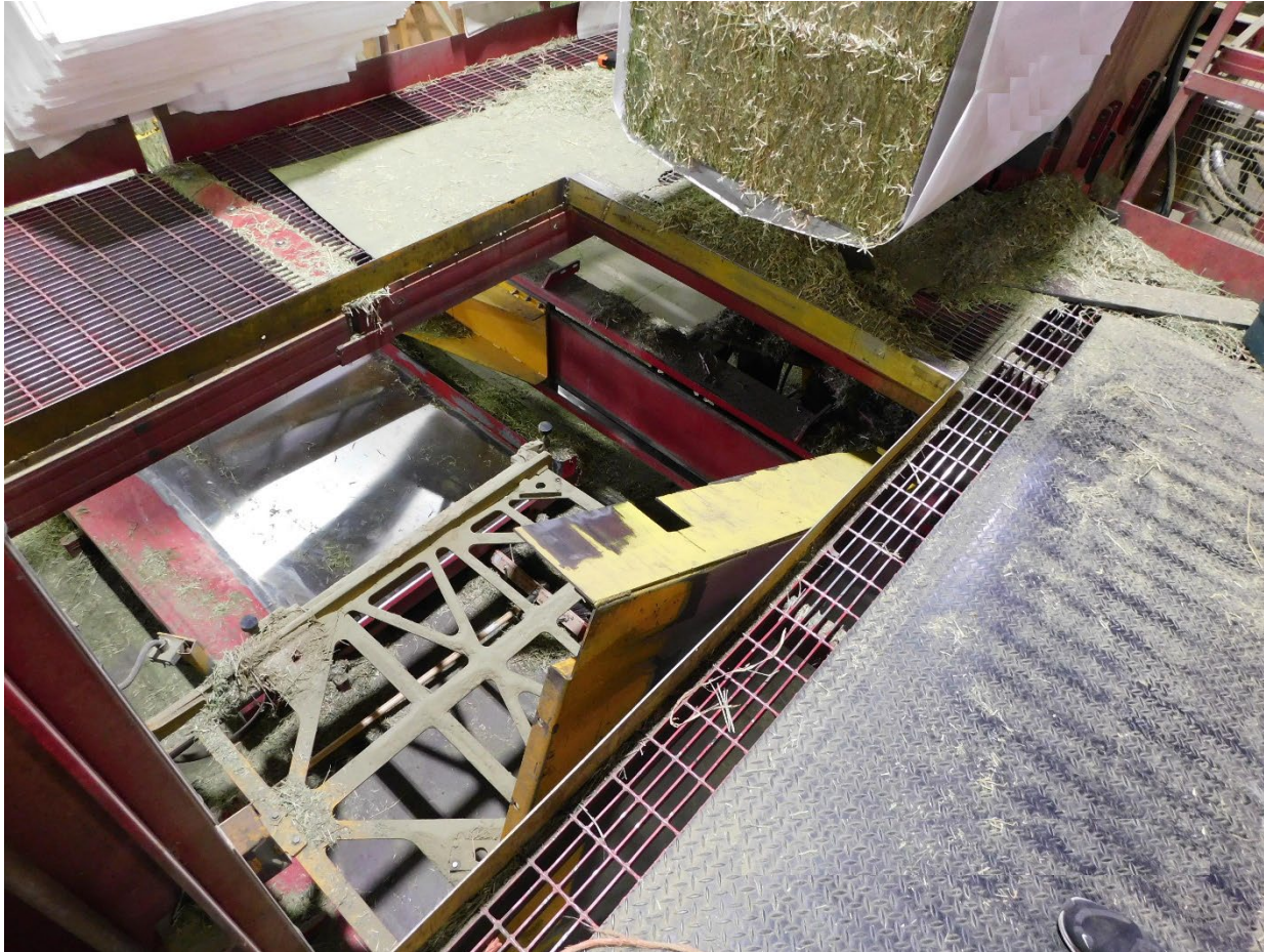
Fotografía 4. Vista superior del elevador de pacas de heno y la plataforma de salida desde el área de expulsión y carga de pacas.
