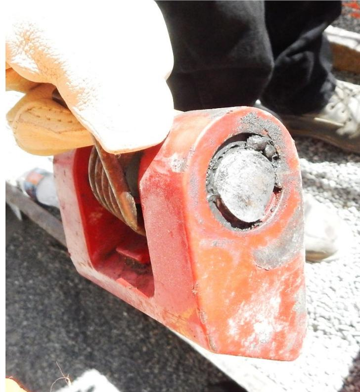
**Fotografías 4 y 5.** Dos vistas de la traba de seguridad que se separó de la máquina y que el observador intentaba volver a poner cuando se le aplastaron los dedos.
