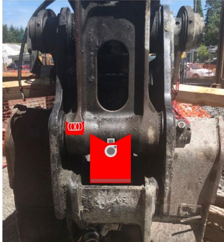
**Fotografía 1.** El acoplador rápido que conecta el cangilón con el brazo de la excavadora, con ilustraciones de las ubicaciones aproximadas de la cuña (al centro) y la traba de seguridad (a la izquierda). No se muestra a escala.
