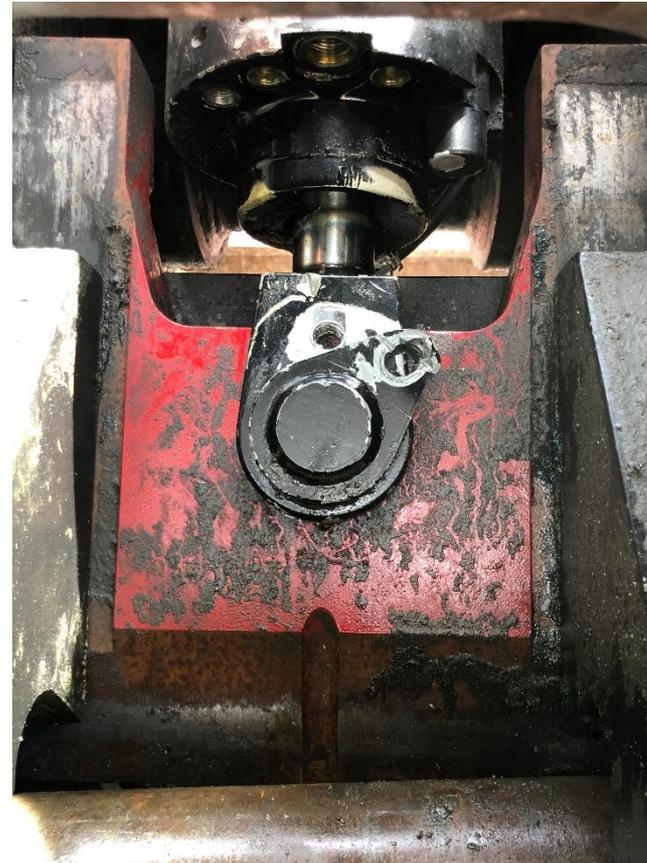
**Fotografías 2 y 3.** Vista del pistón dentro del acoplador a la izquierda y primer plano de la cuña en posición desenganchada a la derecha.
