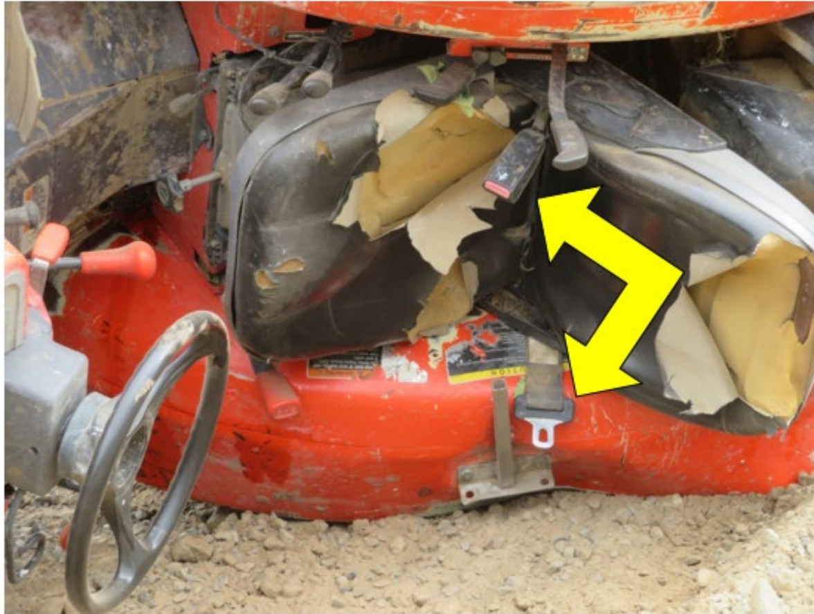
Fotografía 3. El cinturón de seguridad del operador estaba desabrochado en el tractor que se volcó. Obsérvense las etiquetas de advertencia desgastadas en el guardabarros izquierdo.
