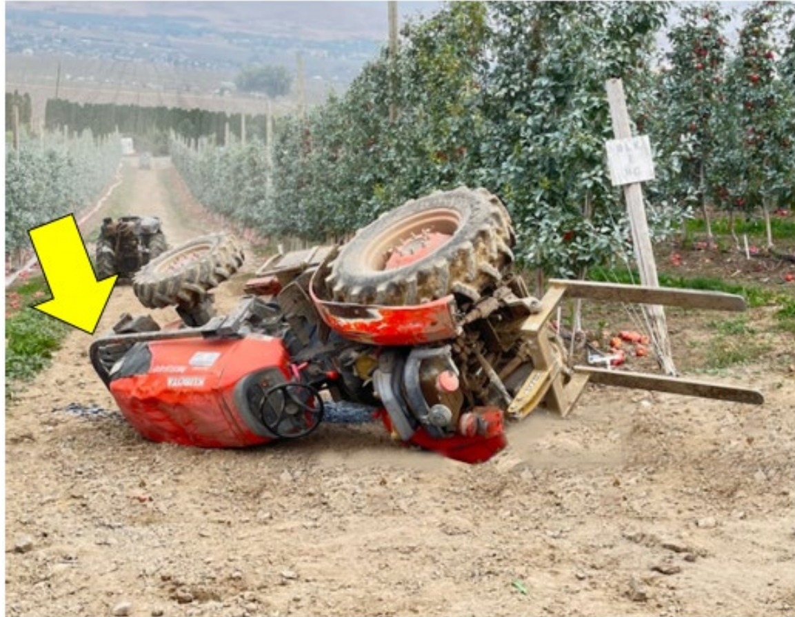
Fotografía 1. Tractor con la ROPS plegada en el lugar del vuelco.
