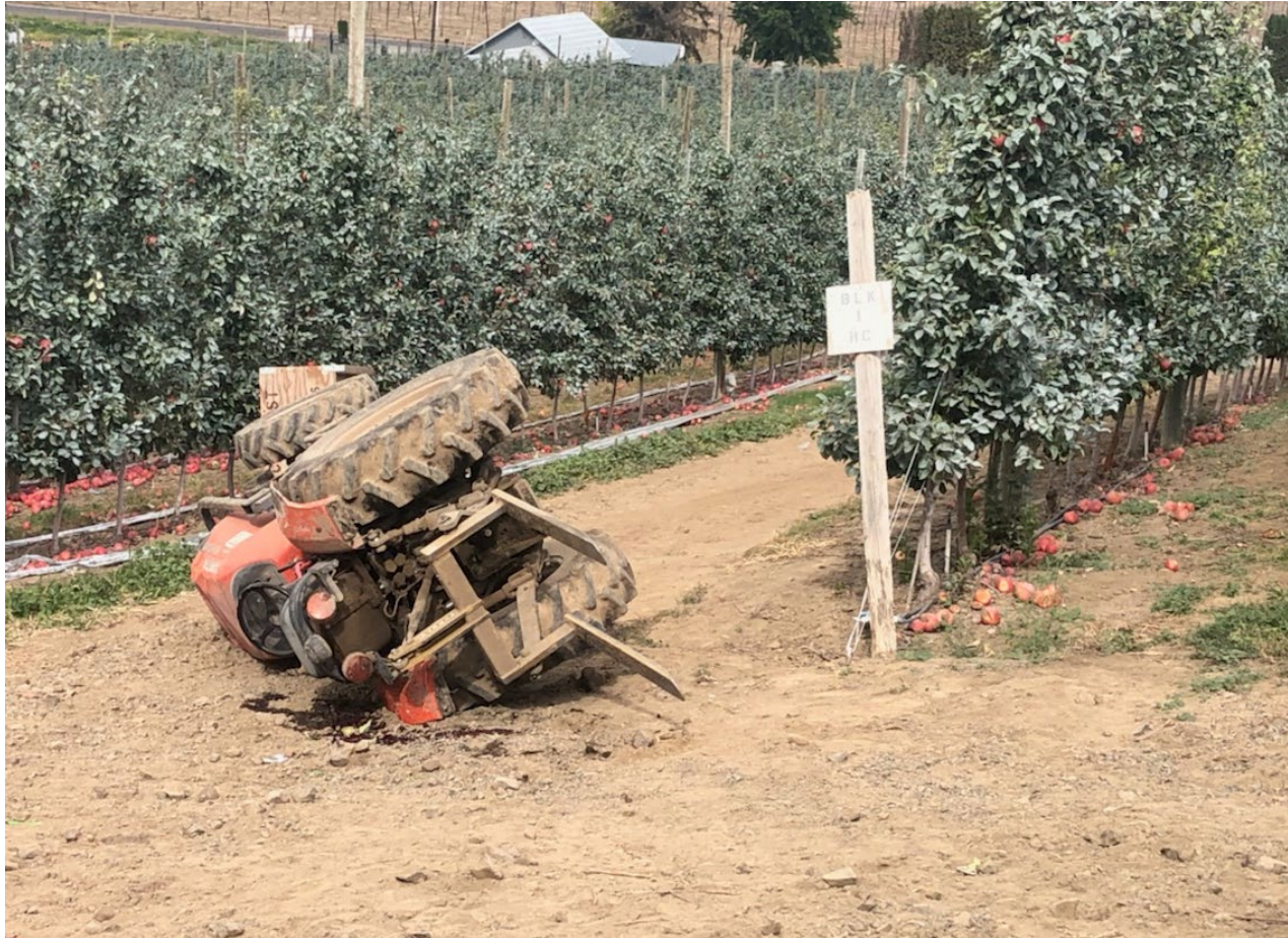
Fotografía 2. Vista trasera del tractor con las horquillas ensambladas en el lugar del vuelco.
