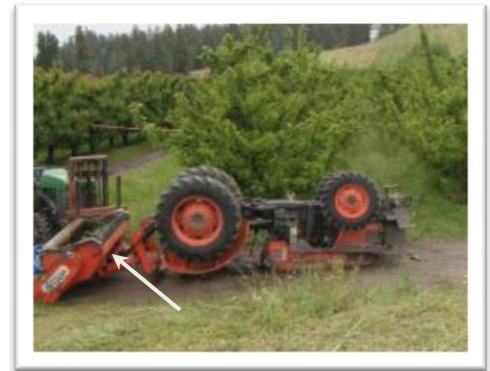
Algunos accesorios pueden cambiar el centro de gravedad haciendo que el tractor pueda volcarse más fácilmente.
