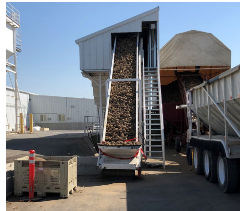
La cinta transportadora elevadora se sobrecargó con papas, lo que ocasionó el atasco.
