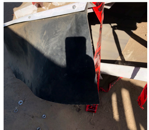
El protector de los rodillos que el trabajador lesionado levantó para acceder a la cinta.
