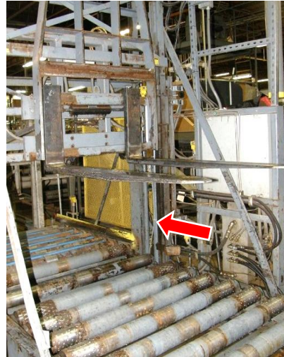
Desapilador de bandejas con horquillas elevadas. La flecha apunta al cilindro que el mecánico estaba intentando reemplazar.
