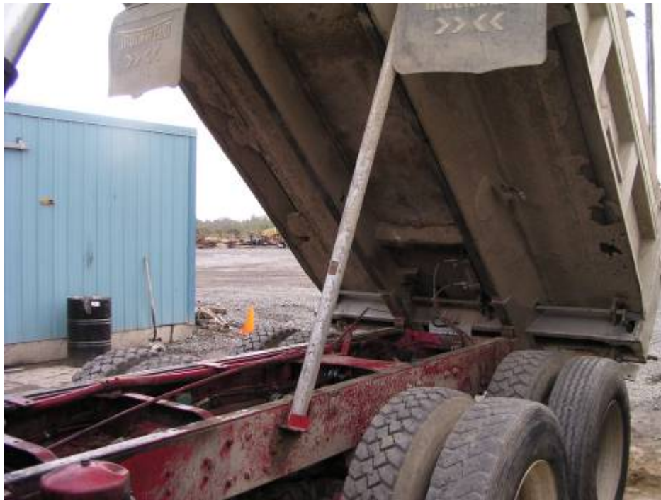
Figura 1. El camión después del incidente con la caja levantada y la tranca de seguridad en su lugar.
