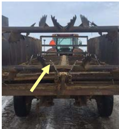
Fotografía de las barras del esparcidor de paja. La flecha indica dónde se enredó la ropa del trabajador en la barra giratoria del batidor.
