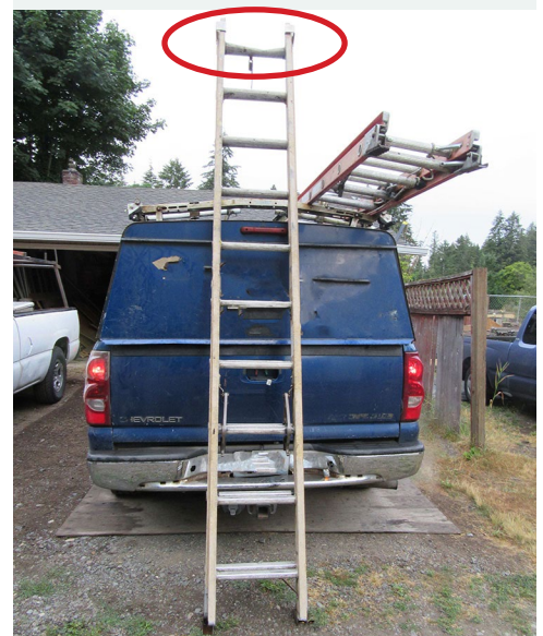
Figura 2: La escalera de extensión de fibra de vidrio involucrada en el incidente fue dañada. El peldaño superior de la escalera estaba doblado (en el círculo). Se informó el daño al empleador, pero la escalera no se retiró del servicio ni se reparó.
