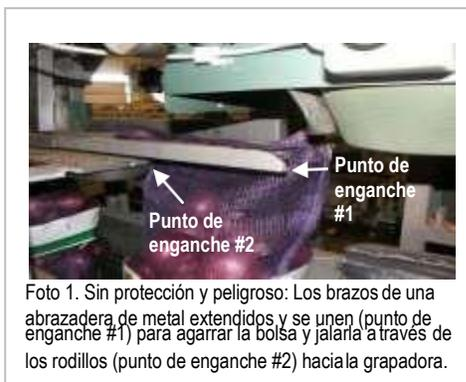
Foto 1. Sin protección y peligroso: Los brazos de una abrazadera de metal extendidos y se unen (punto de enganche #1) para agarrar la bolsa y jalarla a través de los rodillos (punto de enganche #2) hacia la grapadora.
