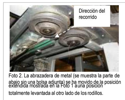
Foto 2. La abrazadera de metal (se muestra la parte de abajo sin una bolsa adjunta) se ha movido de la posición extendida mostrada en la Foto 1 a una posición totalmente levantada al otro lado de los rodillos.
