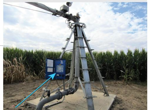
Un empleado subió a la torre pivotante para solucionar un problema cuando murió electrocutado. El trabajador no siguió el procedimiento escrito de bloqueo/etiquetado específico del empleador que requiere la desactivación en el panel de control azul.
