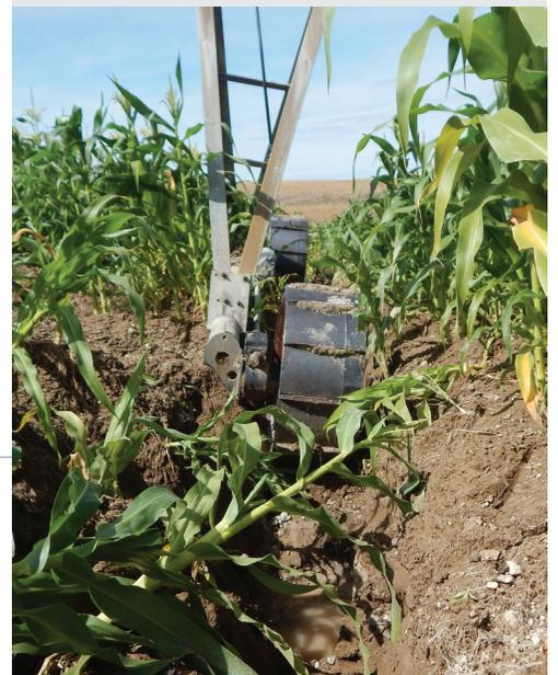
Un empleado quedó atrapado en el lodo y murió aplastado bajo la rueda de una torre de extremo móvil.
