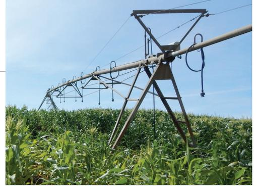
Los sistemas de riego de campo, como se muestra en esta foto, son grandes estructuras metálicas que pueden abarcar 1,200 pies y a menudo se impulsan con 480 voltios.
