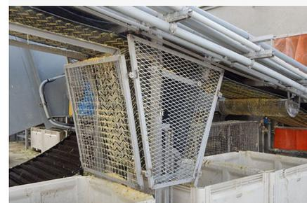
Происшествие 1: конвейерная лента и ролики, которые работодатель после происшествия закрыл защитным ограждением. Защитное ограждение приварено к раме.
