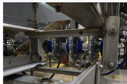
Происшествие 2: конвейерная лента и зубчатые колеса цепной передачи, в которых застряла рука рабочего. Примечание: на фотографии лента демонтирована.
