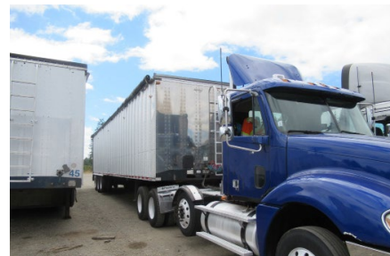
Несчастный случай 1: Грузовик и прицеп, участвовавшие в инциденте. Водитель упал с лестницы, расположенной на передней части прицепа.
