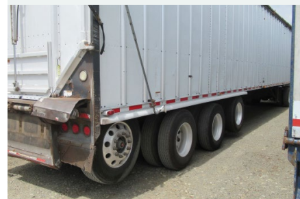
Несчастный случай 1: Рукоятка кривошипного механизма, используемого для перемещения брезента. Водитель вращал эту ручку до тех пор, пока брезент не застрял.
