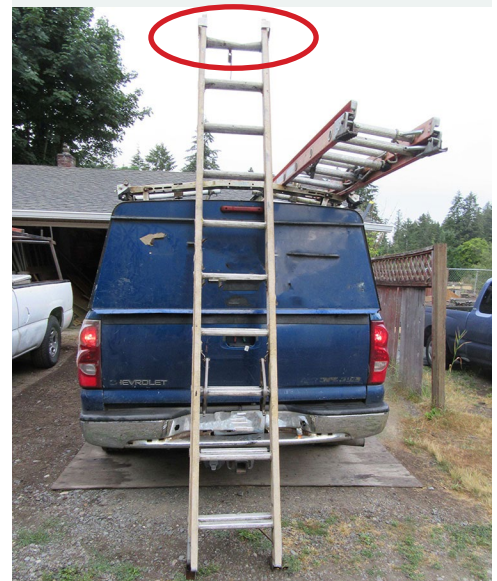
Рисунок 2: Стеклопластиковая приставная лестница, с которой произошел инцидент, была повреждена. Верхняя перекладина лестницы была погнута (обведено кружком). О повреждении было сообщено работодателю, но лестница не была выведена из эксплуатации или исправлена.
