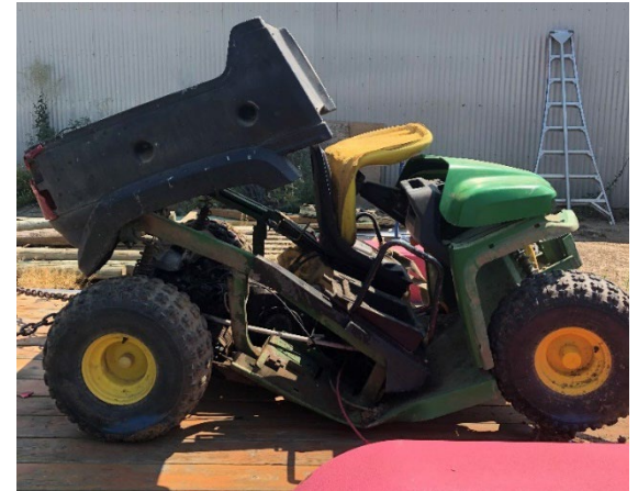
Vehículo utilitario (UTV) con daños por colisión provocados por el vehículo de pasajeros.
