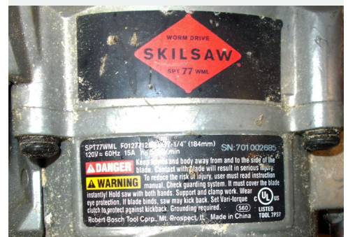
La etiqueta de la sierra explica con claridad que la sierra debe sujetarse con ambas manos. También advierte que, si la hoja se atasca, la sierra puede retroceder de golpe.
