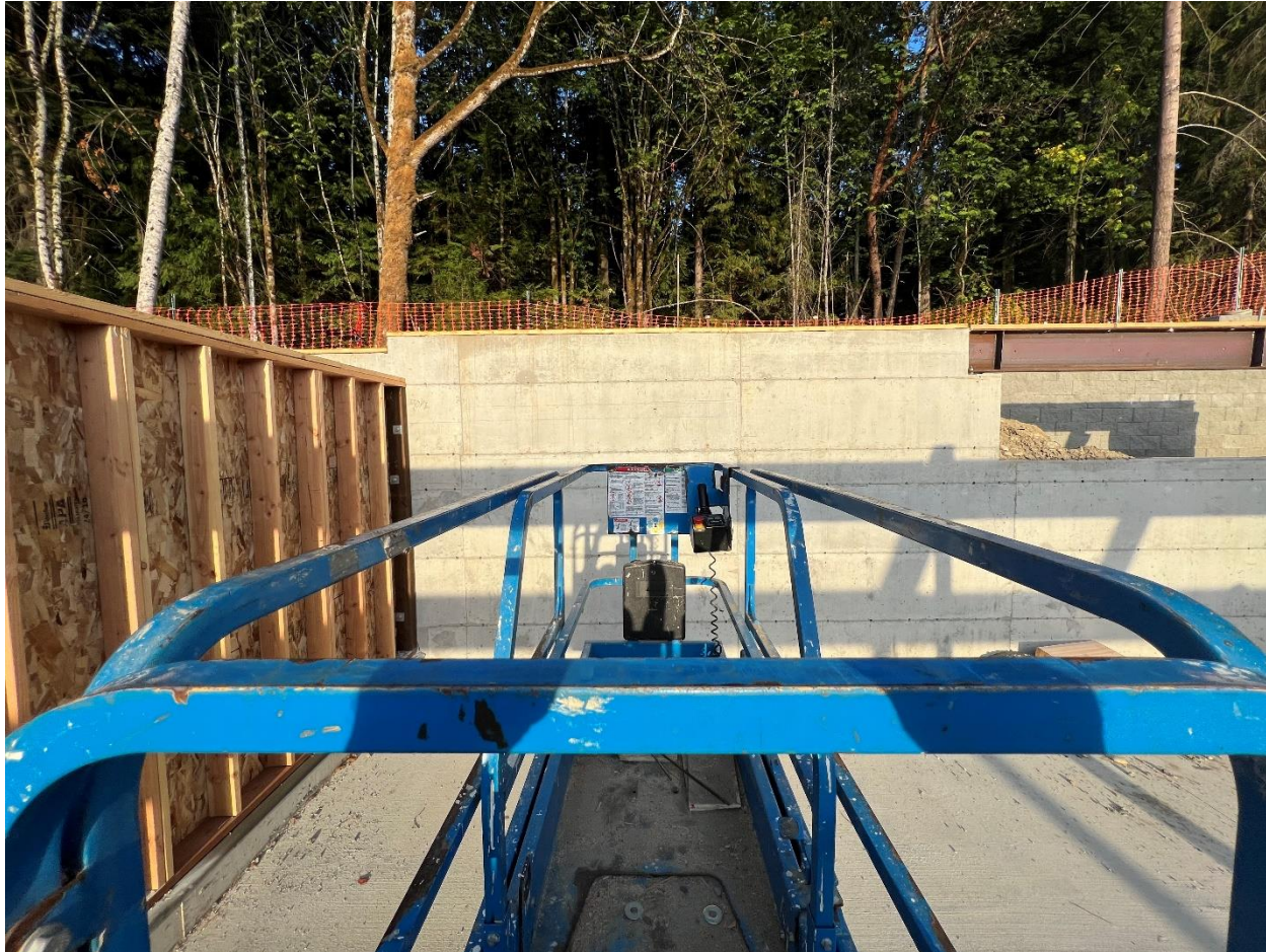
Fotografía 3. Barandilla superior de la plataforma elevadora.
