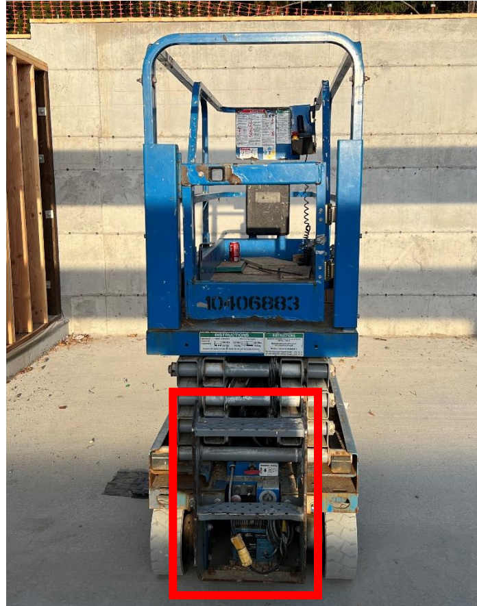
Fotografía 2. Vista trasera del elevador con los escalones señalados en rojo.
