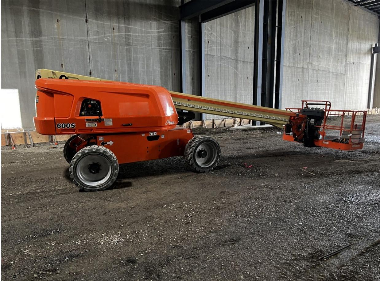
**Fotografía 5.** Plataforma elevadora con canastilla utilizada como plataforma de detención de caídas.
